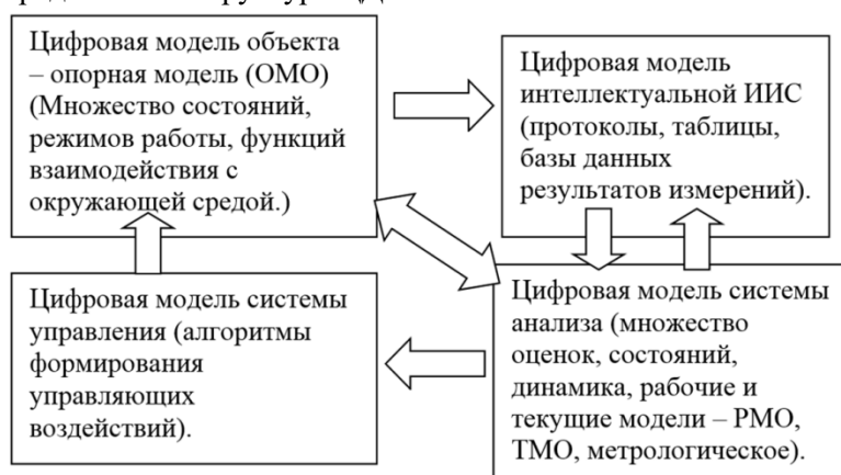
Рис. 1 – Структура цифрового двойника ИИУС
